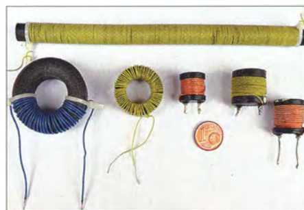
Bild 2: Umgewickelte Entstördrosseln, Ringkern- und Ferritstabspulen
