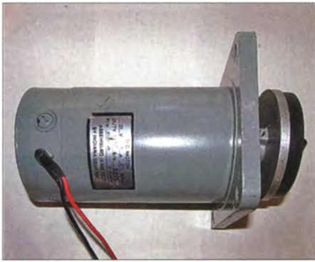
Bild 3: Schwerer Langsamläufer, Nenndrehzahl 375 min -1 bei 24 V und 5 A
