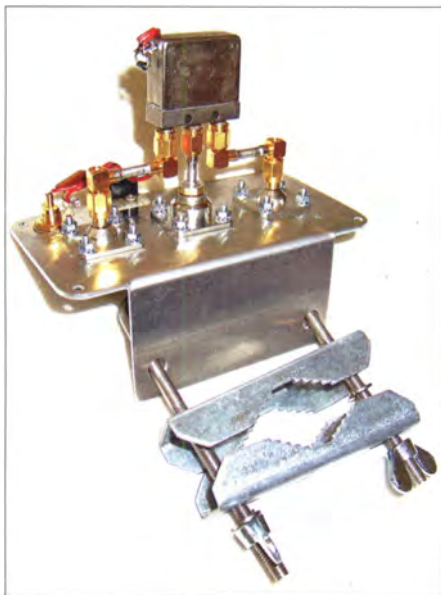
Bild 1: Innenleben des Mastgehäuses mit eingebautem SMA-Relais; der Aluminium-Bodenwinkel trägt auch die Mastschelle.
