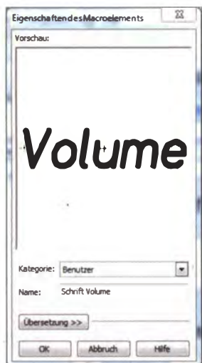
Bild 4: Aus der Gravur „Volume“ lässt sich ein Makroelement erzeugen – zur baldigen Wiederverwendung.
