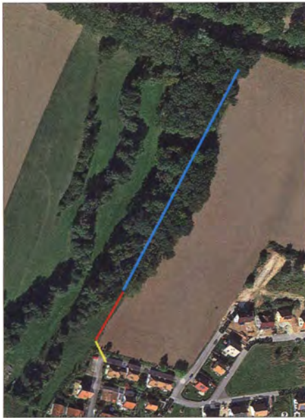
Bild 2: Die Beverage bei DL1AMQ wird vom Standpunkt am Haus über ein unter der Straße geführtes 15 m langes 75-Ω-Erdkabel (gelb) und weitere 49 m über das in einem Verlegerohr untergebrachte 75-Ω-Kabel (rot) gespeist. Dann folgen am Anfang der Beverage (blau) die Speisetransformatoren T1 und T2 sowie am Ende der Reflexionstransformator (T3). Screenshot: Google Maps
