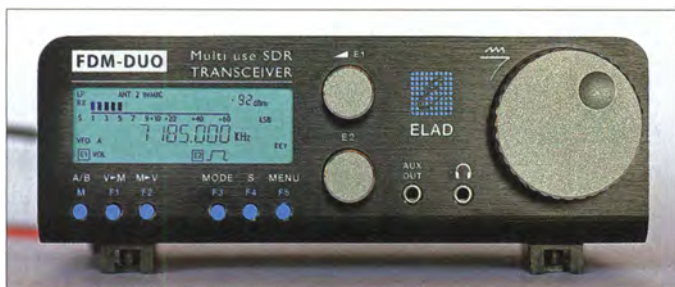
Der FDM-DUO lässt sich komfortabel direkt am Gerät bedienen oder per Computer steuern.
