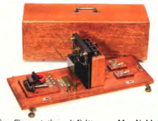
Empfängerstation mit Fritter von Max Kohl, 1903 Demonstrationsmodell für drahtlose Telegraphie nach Marconi – (€ 2.500 – 4.000)
