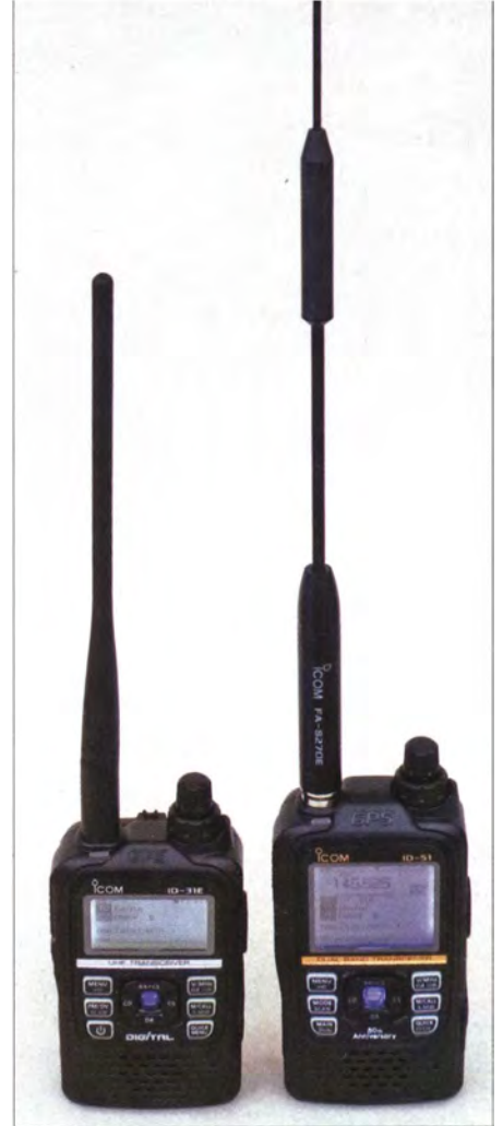
Bild 2: Die deutlich längere Antenne FA-S270E verbessert die Reichweite spürbar.
