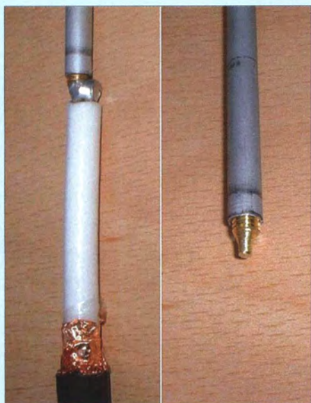
Bild 3: Der Lötanschluss des Strahlers besteht aus einem in das Aluminiumrohr eingedrehten Messingzapfen.
