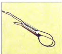
Bild 5: Der Nitinoldraht lässt sich über Adernendhülsen verbinden und befestigen.
