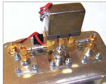
Bild 3: Die Verbindung zwischen Relais und N-Buchsen erfolgt mit Semi-Rigid-Kabel. Fotos: DG5VL
