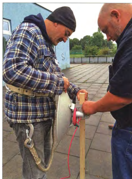
Tom Fritz, DL6SE (l.), und Klaus Rheinheimer, DH5IAO, von der AGµC beim Einrichten der Ubiquiti-Nanostation für den HAMNET-Link zu DB0UKW in JN49HM.
