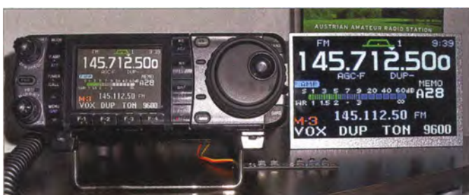
Bild 1: Größenvergleich des Displays im IC-7000 mit dem etwas weiter hinten stehenden LC-Display von Pol- lin; auf dem Tisch liegt die schmale Platine des Bedienteils.
