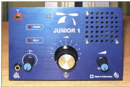
Blickfang auf der Fensterbank der Schule war beim Schwarzwaldtreffen der SSB/AM-Empfänger von HB9KOC. Der eloxierte Montagewinkel bildet die Front- und Bodenplatte. Foto: DH8DAP
