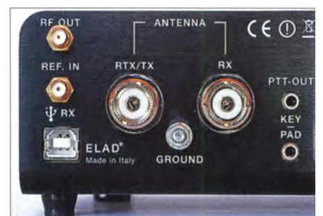
Ein zweiter Antenneneingang (rechts im Bild) ermöglicht den Betrieb einer separaten Empfangsantenne; links eine USB-Schnittstelle.
