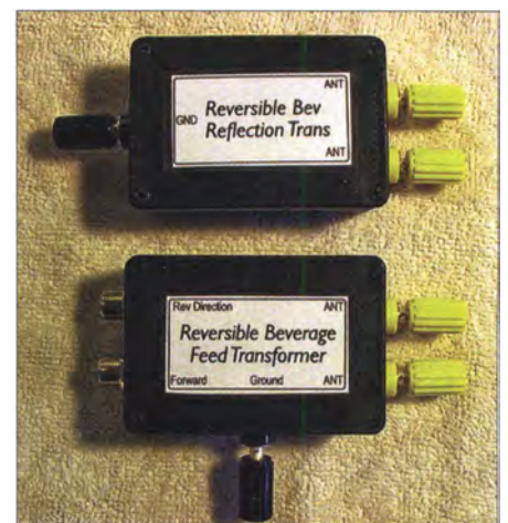
Bild 4: Für die Beverage nutzbares Transformer Kit von KD9SV Fotos: DL1AMQ
