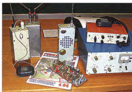
Bild 2: Selbst gebaute FM-Funkgeräte aus den Achtzigern anlässlich einer Ausstellung 2006 (der blau-weiße Transceiver rechts unten gehört nicht dazu). Foto: DL3VL
