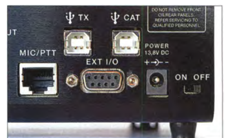
Insgesamt drei USB-Schnittstellen sichern die umfassende Anbindung an einen Computer.
