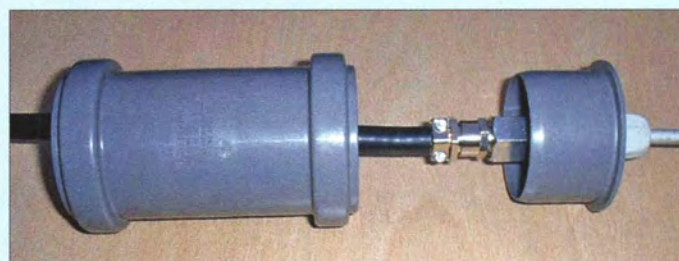
Bild 2: Verschraubte Einzelteile mit Kabelanschluss am Antennenfußpunkt
