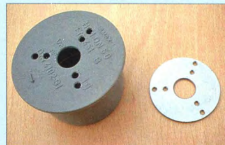
Bild 5: Gebohrter Abschlussdeckel mit Karoseriescheibe
