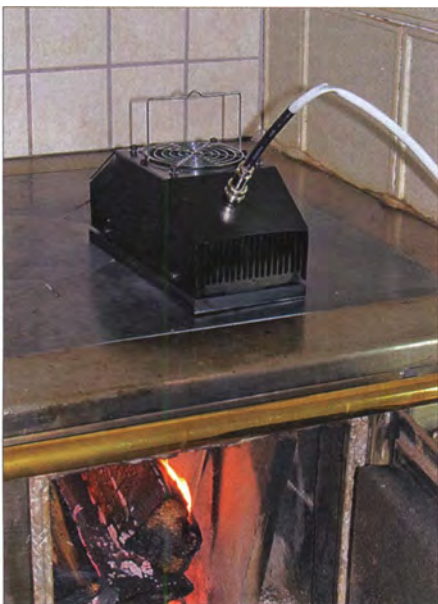
Bild 8: Thermogenerator von [8] in Betrieb über einem abgedeckten offenen Feuer
