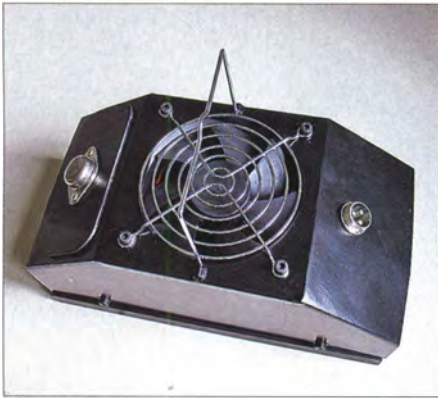
Bild 7: Thermogenerator mit 15 W Nennleistung von [8]
