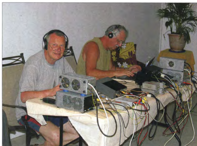
Hans, KH8/DL6JGN (l.), und Günter, KH8/DL2AWG, an den Stationen; bestehend aus K3 mit 500-W-Transistor-PA und MK2 für Digimodes sowie K2 samt 500-W-Transistorendstufe, auch als Josef-PA bekannt
