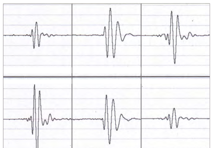
Bild 12: Diese unterschiedlichen Impulsverhältnisse können bei einer gegenphasigen Einwirkung des Sekundärfeldes auftreten; links bei kleinerer Amplitude, Mitte bei gleicher Amplitude und rechts bei größerer Amplitude.
