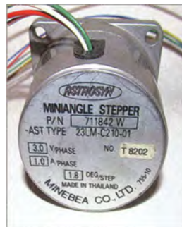
Bild 5: Schrittmotor aus einem Nadeldrucker; beachten Sie hinsichtlich Ansteuerspannung und Stromaufnahme die Angaben auf dem Typenschild.
