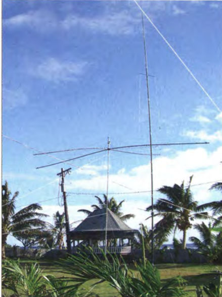
Der Spiderbeam für 20 m bis 10 m und die Vertikalantenne für 20 m, 15 m und 10 m
