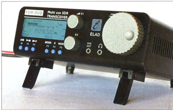
Zwei ausklappbare Stützen bringen den Transceiver in eine günstige Bedienlage. Der große VFO-Knopf ermöglicht die komfortable Einstellung der Frequenz sowie weiterer Parameter.
