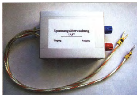
Bild 7: Gehäuse und Anschlüsse sollten eindeutig beschriftet sein. Fotos: DJ6YO
