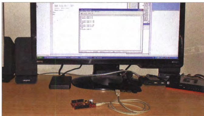
Bild 7: Über den Controller auf dem Arduino-Board werden zwei Zahlen addiert und das Ergebnis zum Terminalprogramm des PC gesendet.
